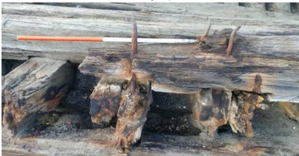
شکل ۳۰- جزئیات کشتی تاریخی قروق: میخ‌های روسی برای اتصال قطعات مختلف کشتی (طول این میخ‌ها یک متر است) (توفیقیان، ۱۳۹۸)
