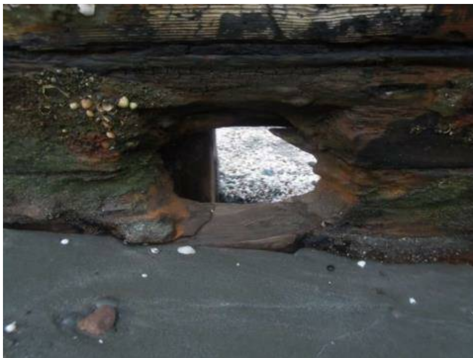
شکل ۲۳- یک سوراخ بزرگ در بدنه کشتی که شاید دلیل غرق شدنش باشد. (توفیق‌یان، ۱۳۹۸)
