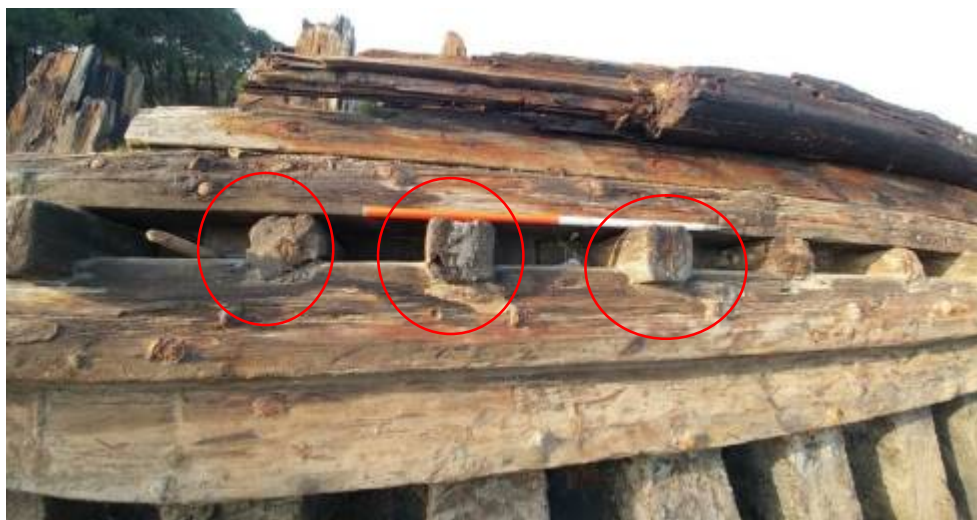
شکل ۲۹- جزئیات کشتی تاریخی قروق: اتصالات چوبی که در کنار میخ‌های فولادی بخش‌های مختلف را به هم متصل می‌کردند. (توفیقیان، ۱۳۹۸)
