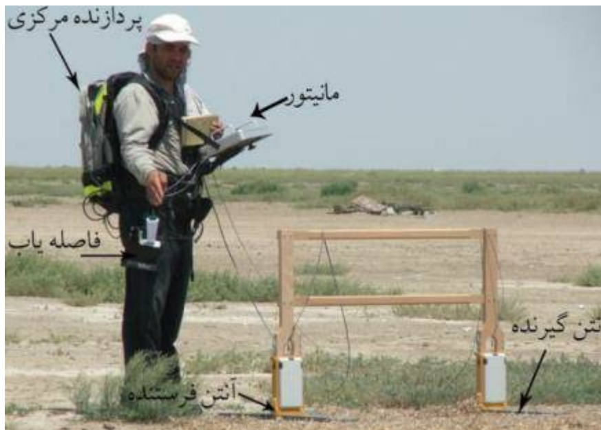
شکل ۱۰- دستگاه ژئورادار و بخش‌های مختلف آن. (نادری بنی، ۱۳۸۵)
